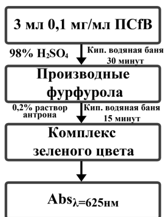
Рис. 1. Схема методики количественного определения ПСfВ
