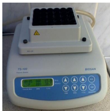
Рисунок 3. Термостат для пробирки типа «эпшендорф» от 25 до 1000^{\circ}\text{C} ThermoShakerTS-100, BIOSAN
