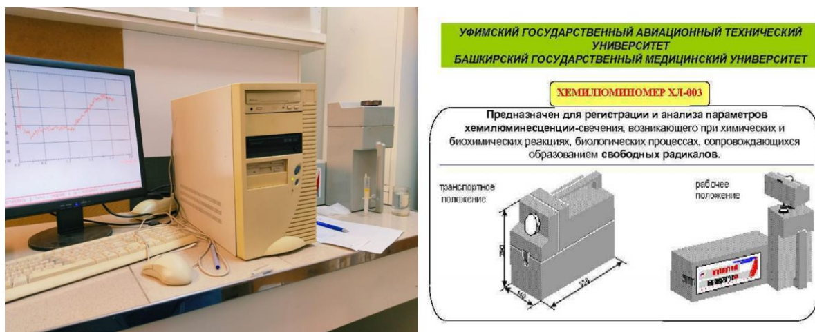
Рис. 10. Система хемилуминомера ХЛ-003, выполняющая регистрацию активных форм кислорода в исследуемом материале в модельной системе АФК.
