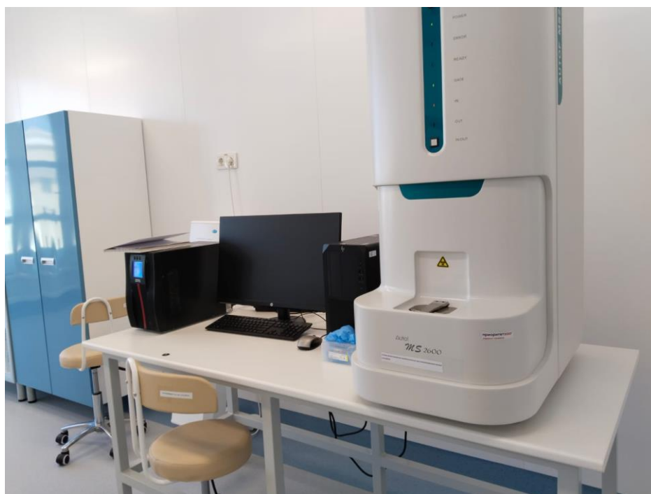
Рис. 9. Система масс-спектрометра Autof MS 2600, выполняющая масс-спектрометрический анализ методом MALDI-TOF.
