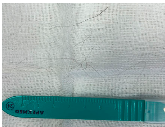
Рисунок 6. Извлеченный фрагмент расплетенного коронарного проводника
