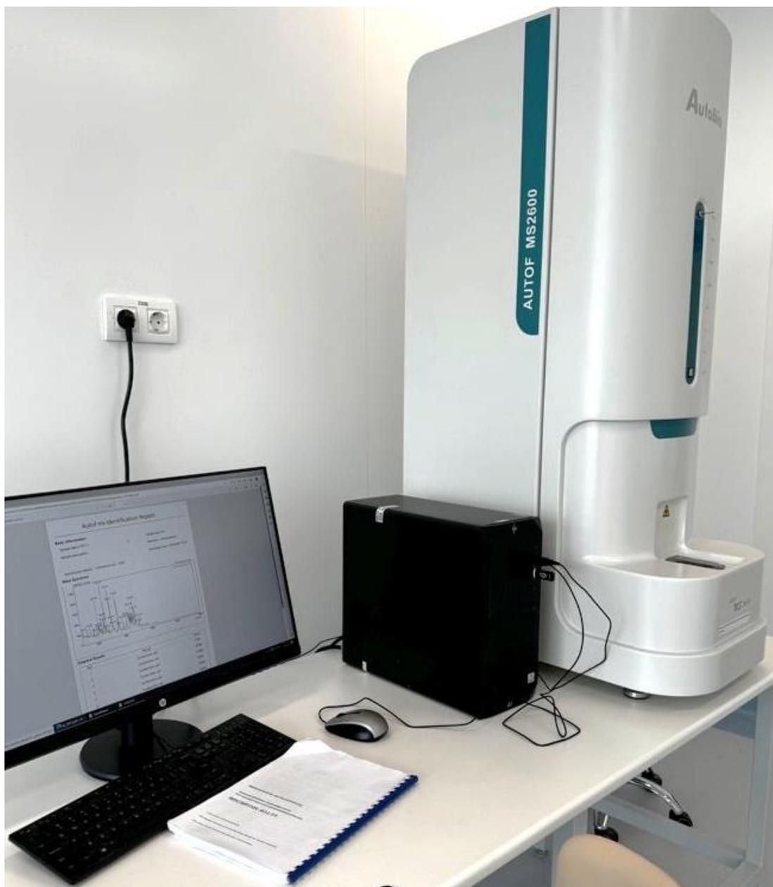
Рисунок 4 – Автоматизированный масс-спектрометр для идентификации микроорганизмов AUTOF MS1600/2600.
