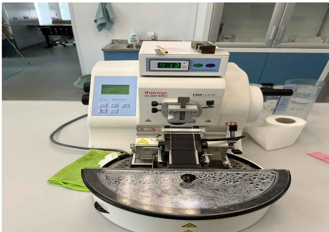
Рисунок 5 - Ротационный микротом модели HM340E с системой вылавливания срезов (thermo scientific. Великобритания)
