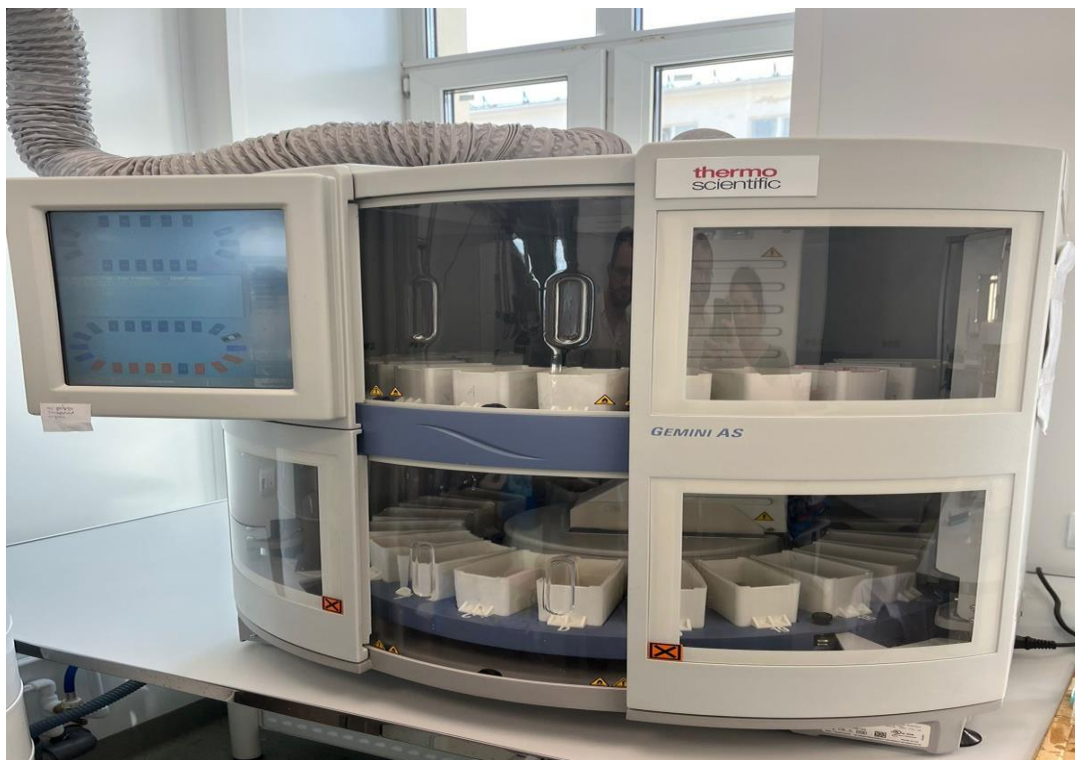
Рисунок 6 - Аппарат для окрашивания стеклопрепаратов GeminiAS фирмы Thermo Scientific. Великобритания
