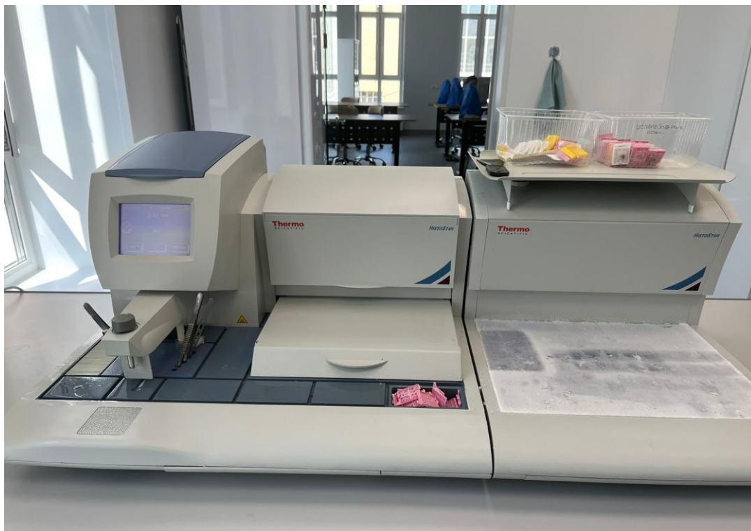
Рисунок 4 - Станции заливки Histostar фирмы Thermo Scientific, Великобритания
