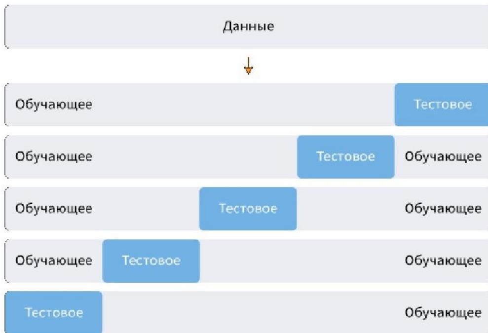
Рис. 31. Принцип работы метода кросс-валидации.
