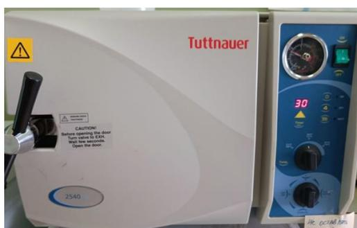
Рисунок 4 – Автоклав для стерилизации сред и лабораторного оборудования
