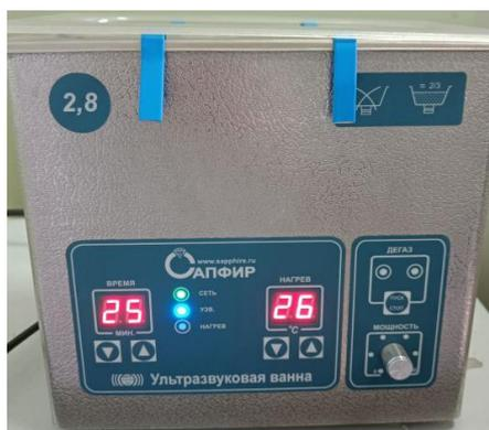
Рисунок 7 – Ультразвуковая ванна для отмывания образцов
