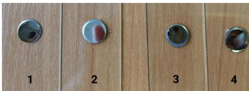
Рисунок 2 – Образцы титана с наноструктурированной поверхностью. Номера 1,4 – обработанная поверхность, номера 2,3 – поверхность не обработана
