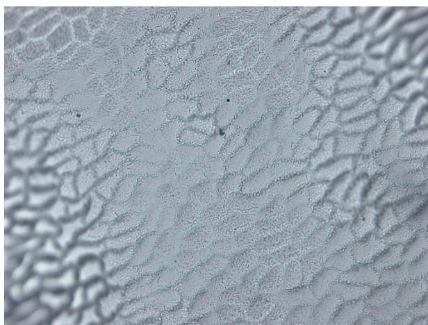
Рис 11 – Образец М. Модифицированная поверхность силикона методом литографии. Световая микроскопия
