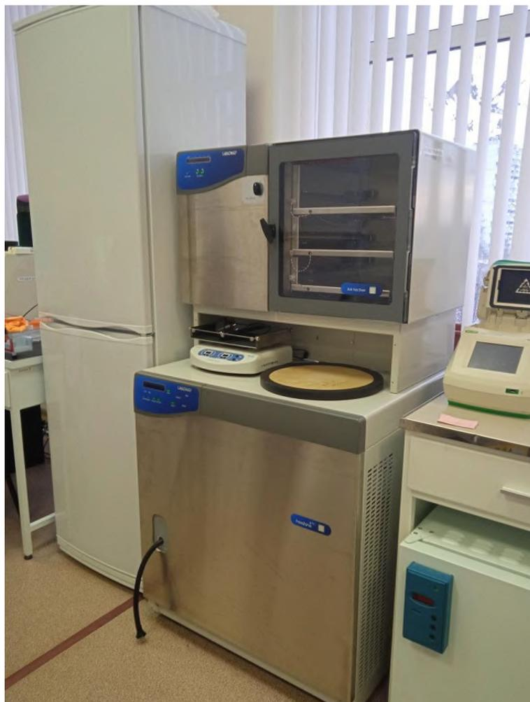
Рисунок 1 – лиофильная сушилка FreeZone (Labconco, США).
