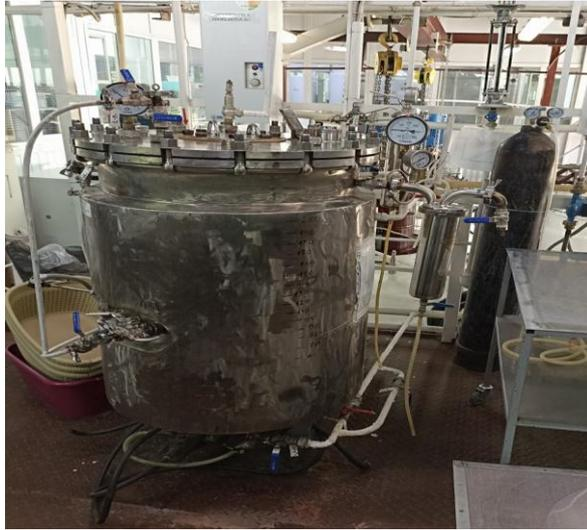
Рисунок 2 – Культивирование бактерий в реакторах объемом 200 л
