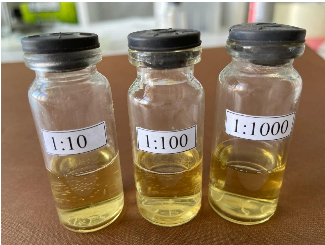
Рисунок 4 – биосурфактанты, полученные из суспензии бактерий B. altitudinis , в разведениях 1:10 (1740 КОЕ/мл), 1:100 (920/мл КОЕ/мл), 1:1000 (40 КОЕ/мл)
